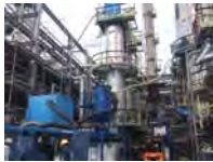
DCC Load/Unload Catalyst มีถัง Dust Collector เพื่อป้องกันฝุ่น
